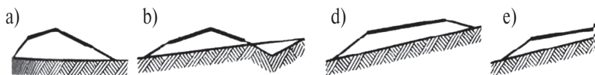
5.4-rasm. Sun'iy qoplamalar ko'ndalang profilning turlari a, b - ikki nishabli; d, e - bir nishabli.
